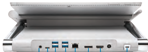
Prise audio de 3,5 mm (entrée et sortie) Port USB-C® Quatre ports USB 3.0 Port Gigabit Ethernet Port DisplayPort++ Port HDMI Encoche de sécurité Kensington™
