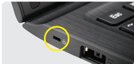
Encoche de sécurité Nano Security Slot™ de Kensington
